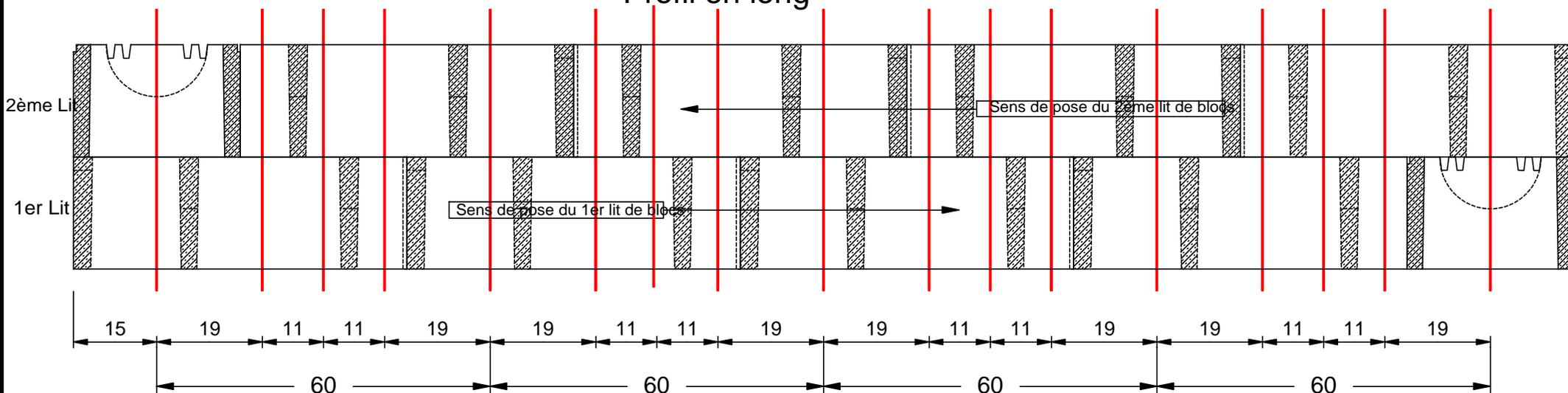
Résumé : placer la 1ère barre à 15 cm de l'extrémité du mur puis respecter un cycle de (19 + 11 + 11 + 19 cm) entre les barres suivantes.
